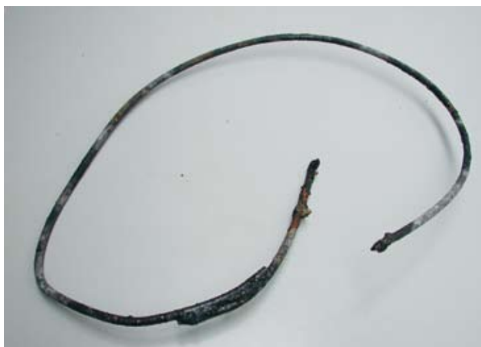
Der Schmelzpunkt von Aluminium beträgt 660.4 Grad! Beim Verbrennungsprozess herrschen mitunter Temperaturen bis zu 2000 Grad. Der Test zeigt, dass die Alubüchsen offensichtlich geschmolzen oder gar verdampft sind: Am Draht und in der Schlacke sind keine Schmelzrückstände vom Aluminium zu finden, und sogar der dicke Draht ist durchgeschmolzen.
