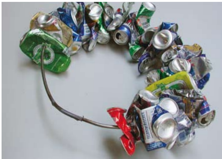
Aludosen auf dickem Draht aufgereiht. Testablauf: 12:10 Uhr: Aluminiumdosen, die mit Draht zum Teil an grösseren Eisengegenständen befestigt wurden, werden dem Ofen zugeführt. 16:30 Uhr: Erster Gegenstand (dicker Draht) kommt auf Schlackenförderband daher, 17:15 Uhr: Letztes Stück der Versuchsgegenstände hat den Entschlacker verlassen.
