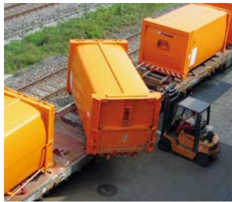
39 Container mit einem Gesamtgewicht von 396 Tonnen werden von zwei Mitarbeitern der KVA in kurzer Zeit entladen. Eine stolze Leistung: Container vom Bahnwagen ziehen, mit dem Entladefahrzeug zum Entladefahren, entleeren und zurück auf den Bahnwagen schieben.
