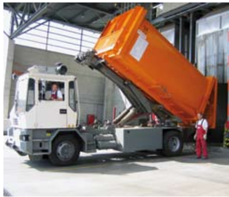
39 Container mit einem Gesamtgewicht von 396 Tonnen werden von zwei Mitarbeitern der KVA in kurzer Zeit entladen. Eine stolze Leistung: Container vom Bahnwagen ziehen, mit dem Entladefahrzeug zum Entlad fahren, entleeren und zurück auf den Bahnwagen schieben.
