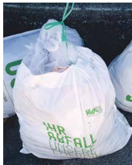
Zu schwer: Beim Hochheben ist der Zugbandsaum gerissen.
