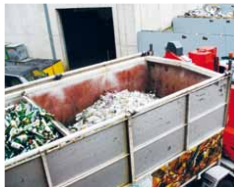
Dank Trennwand im Container können die Fahrzeuge zwei Farbsorten pro Sammeltour aufladen.
