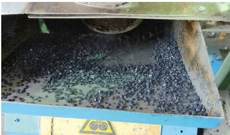
Herstellung von Regranulat aus sortenreinen Kunststoffabfällen bei der Firma InnoPlastics AG in Eschlikon.
