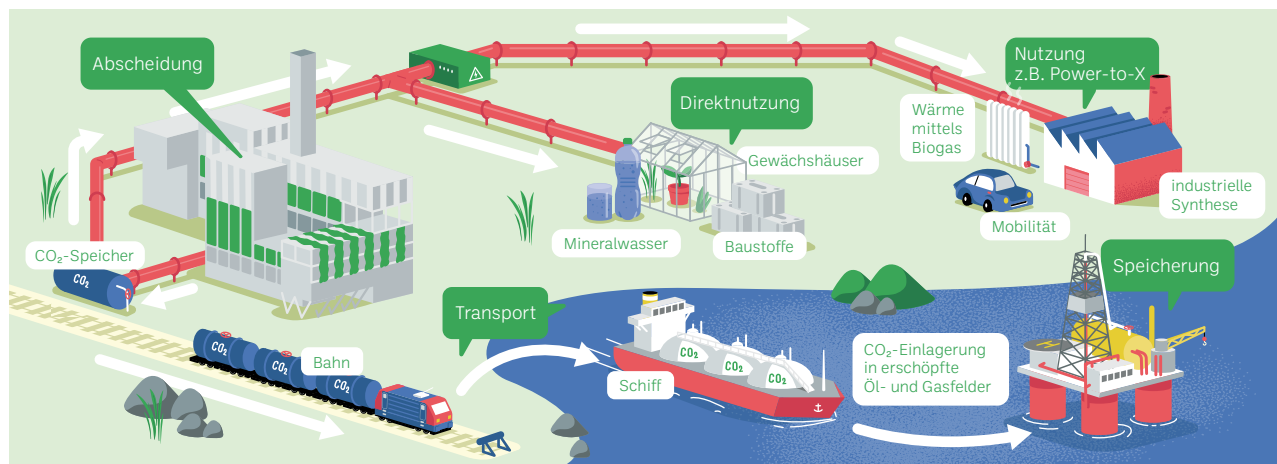
Das in der KVA abgeschiedene CO 2 kann direkt (z. B. in Gewächshäusern oder Baustoffen) oder indirekt (z. B. durch Umwandlung in synthetische Treibstoffe) genutzt werden. Oder es wird im Untergrund deponiert – zum Beispiel in erschöpften Öl- oder Gasfeldern in der Nordsee.
