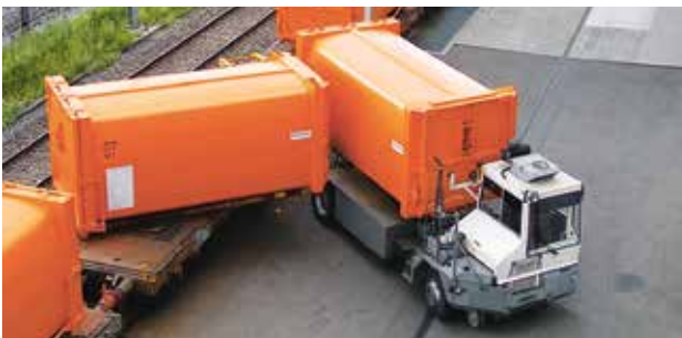
Containerablad auf der KVA-Anlage
