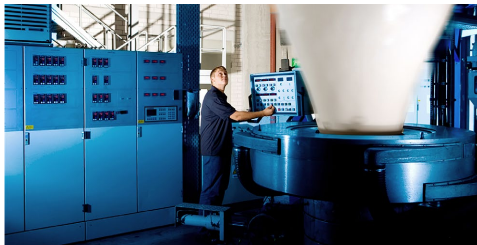
Extrusion - das Granulat wird geschmolzen und zu Folien gezogen.
