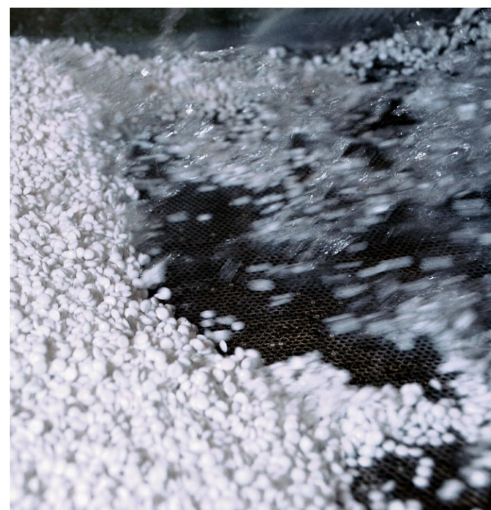
Der Rohstoff - Granulat aus der Kunststoffsammlung.
