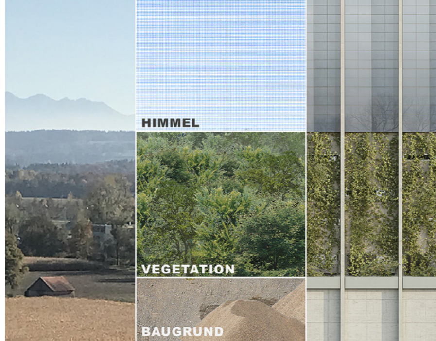
Die Schichtung der Fassade aus Betonsockel, Begrünung und Photovoltaik-Elementen nimmt die Gliederung der Landschaft im Thurtal auf und bewirkt damit eine optische Reduktion des Volumens. Visualisierung: Graber Pulver Architekten.
